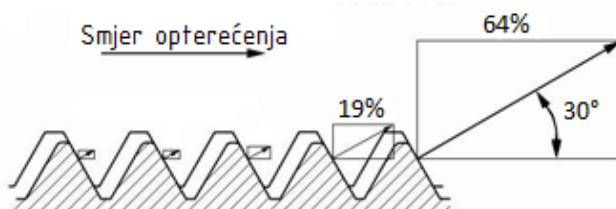
Slika 12. Raspodjela naprezanja u vijčanom spoju (1)
