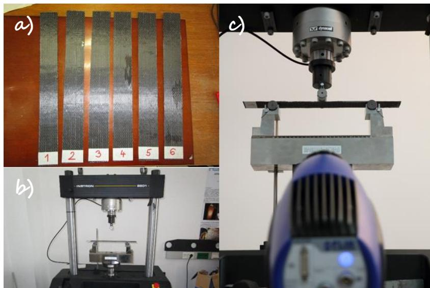
Slika 2. a) Izrađene epruvete, b) kidalica INSTRON 8801, c) savijanje u 3 točke.
