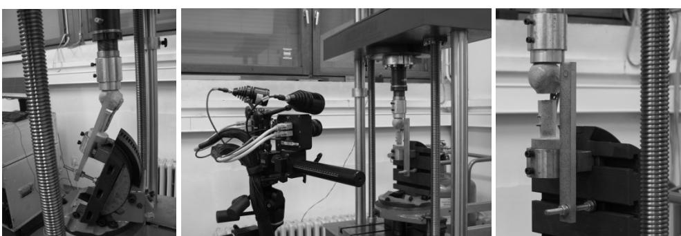
Sl. 3. Opterećivanje ispitnog uzorka i mjerjenje pomaka optičkim sustavom Aramis
