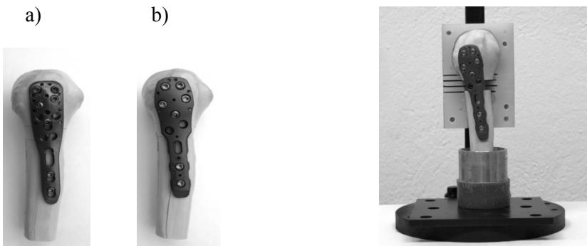
Sl. 1. Pločice na zaključavanje fiksirane na umjetnu kost
