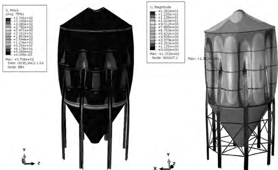
Slika 3. Ekvivalentna naprezanja prema von Misesu u MPa i amplituda pomaka u mm u silosu
