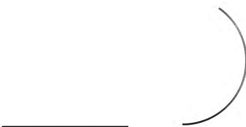
Slika 2. Nedeformirana i deformirana konfiguracija konzole za l_b=0.01 , s mrežom od 64 \times 1 \times 1 Hex27NL elemenata
