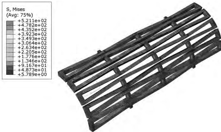
Slika 4. Naprezanja na stentu sa zatvorenom ćelijskom izvedbom u koraku kontrakcije
