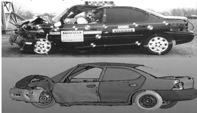
Slika 2. Vizualni prikaz deformacije vozila nakon testa sudara
