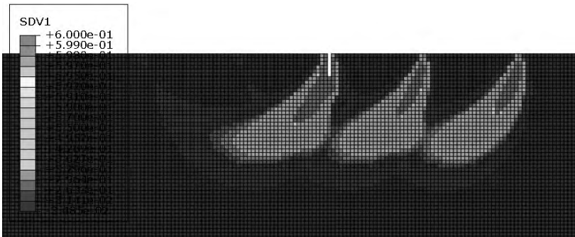
Figure 6. Prikaz tendencije propagacije pukotine nakon ulaska maziva u pukotinu
