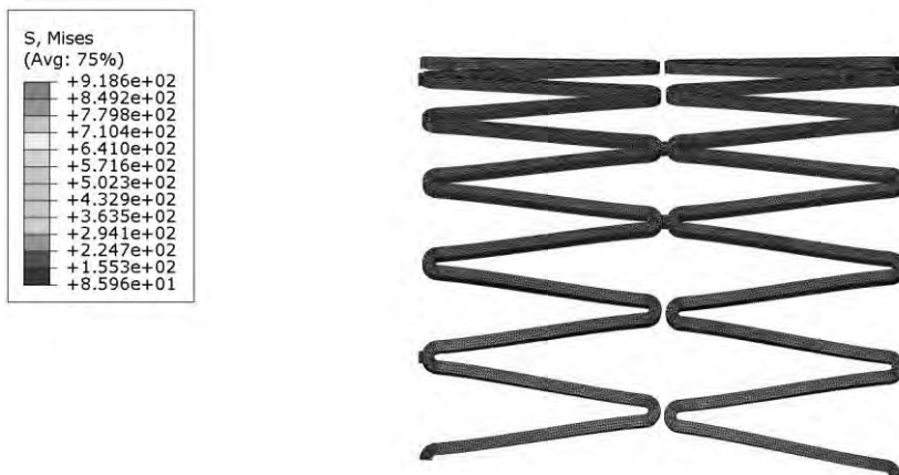
Slika 5. Naprezanja na stentu sa otvorenom ćelijskom izvedbom u koraku ekspanzije
