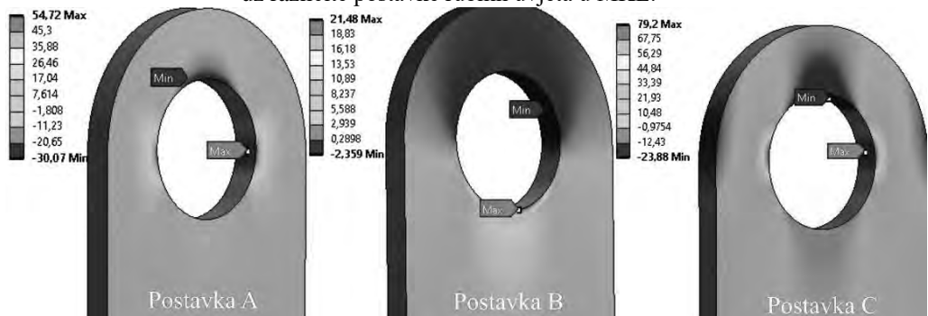
Slika 3. Rezultati za normalna naprezanja dobiveni pomoću SolidWorksa uz različite postavke rubnih uvjeta u MKE.
